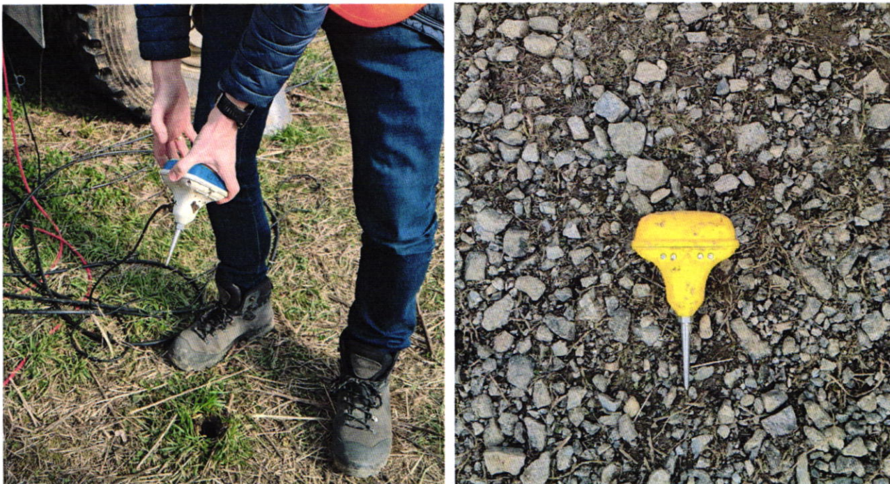
Slika 5. Prikaz geofona (prijamnika)
