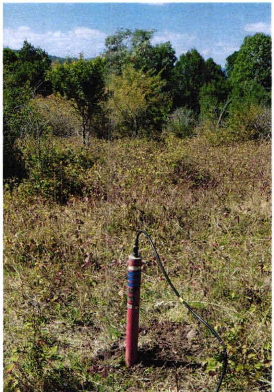
Slika 6. Prikaz sonde koje se koriste pri magnetotelurskom snimanju
